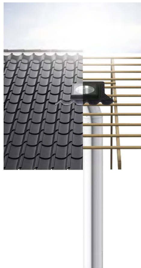
Die hochreflektierende Innenbeschichtung der Sun-Tunnel-Röhre leitet das über den Diffusor einfallende Tages- und Mondlicht bis zu sechs Meter weit in einen darunter liegenden Raum.
