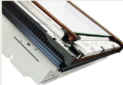
La face intérieur des tôles de recouvrement du vantail revêtu d'un ruban en mousse empêchant la formation de glace et réduit le bruit de la pluie.
