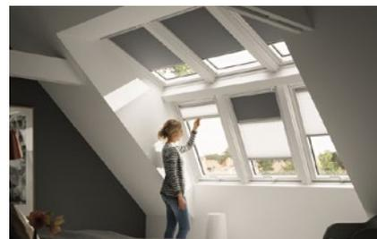
VELUX PANORAMA peut être mise en œuvre comme combinaison de 4 ou 6 fenêtres, dans une sélection de dimensions. L'inclinaison des pièces latérales de construction est de +/- 20°. Les fenêtres peuvent être librement choisies.
