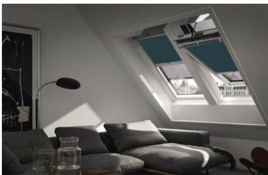
Chaque fenêtre de toit VELUX originale peut être équipée aisément de produits de stores VELUX. Les volets roulants extérieurs et les marquises VELUX offrent une protection optimale contre la chaleur car ils arrêtent les rayons du soleil avant qu'ils ne frappent la vitre. Les nombreux stores intérieurs obscurcissent ou régulent la lumière et placent des accents de couleur décoratifs.
