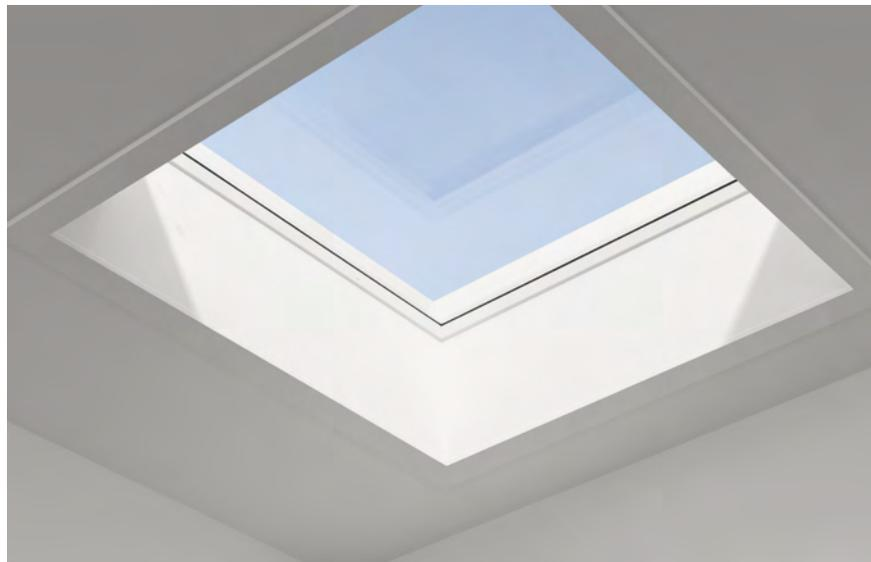
L'embrasure intérieure VELUX pour fenêtre pour toit plat VELUX a été développée pour faciliter le montage. Elle permet de gagner du temps lors du montage, car il n'est plus nécessaire d'enduire et de peindre le plafond. Cette solution complète inclut des panneaux en PVC, un frein vapeur BBX et des baguettes de recouvrement (87 mm).
