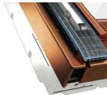
La face intérieur des tôles de recouvrement du vantail revêtu d'un ruban en mousse empêchant la formation de glace et réduit le bruit de la pluie.
