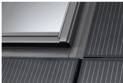
Le cadre applique VELUX pour les installations solaires ODN/ODL a été spécialement développé pour que les fenêtres de toit VELUX s'intègrent parfaitement à une multitude de systèmes BIPV. Le pli latéral sur le cadre applique permet d'installer facilement des tôles d'insertion spéciaux et donc de réaliser une liaison étanche avec l'installation solaire intégrée au toit.
